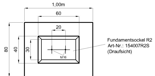
Bei Montage sind die Sockel in eine 10cm hohe Betongrundschicht C20/25KS16 zu setzen und in einer Breite von umlaufend 20cm gemäß Zeichnung anzuarbeiten.
